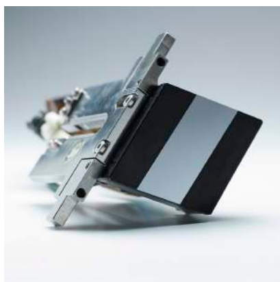
Samba-printkop gebruikt in de Jet Press 750S. Onzichtbaar voor het blote oog, 2048 spuitmonden zijn vervat in de zilverkleurige siliconenchip die slechts 44 mm breed en 18 mm diep meet.
